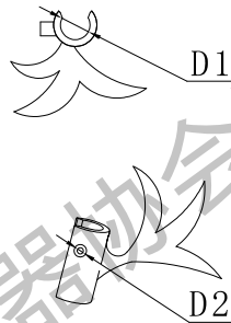
图4 LED 花卉灯叶片卡座接口尺寸示意图
